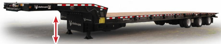
Système de levier qui facilite la connexion à un quai de déchargement (débattement possible de 4 pouces)
