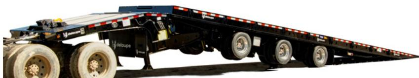
Jack Knife Protection permet à la remorque de travailler dans des positions plus difficiles (en bordure d'autoroute par exemple)
